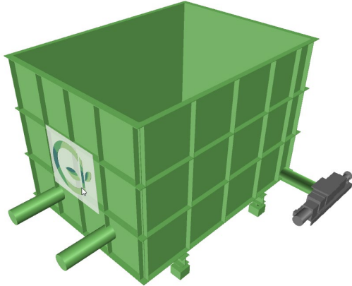
Abbildung 3: Schlammspeicher mit Schlammaustrag
